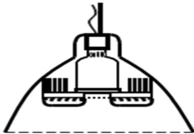
① 電源部、光源部の一体形適用の例
