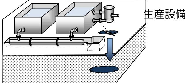
◆平成19年、金属製品製造工場で、溶液槽の配管つなぎ目が劣化し、六価クロムが漏えいし、床面の亀裂から浸透
